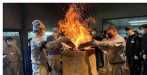
炉に砂鉄と木炭を交互に入れ、「ふいご」で風を送り砂鉄を溶かします。
